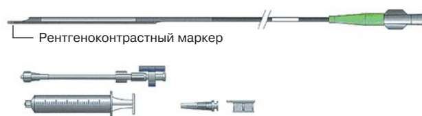
Рис. 8. Принципиальное устройство катетера для мануальной вакуумной тромбоспирации "ELIMINATE" (адаптировано из www.terumo-europe.com ).
